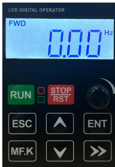
Рис. 4-1. Панель управления. Расположение кнопок управления и индикация
